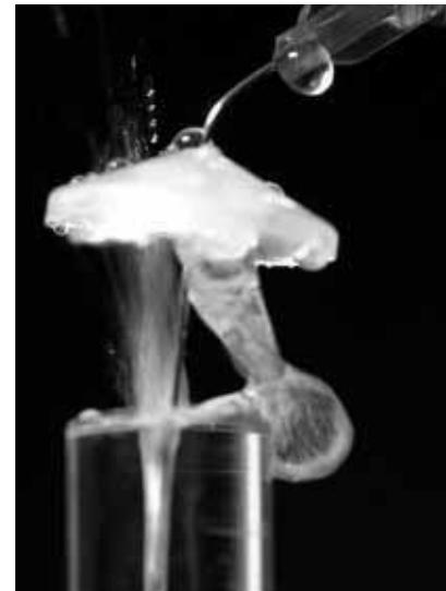
Abb.3: Unter Druck aus dem Zahn(modell) entweichende Spülflüssigkeit
